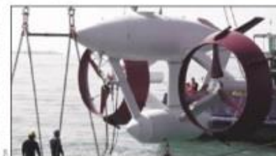
La turbine Gem est installée depuis un an dans la lagune de Venise.
