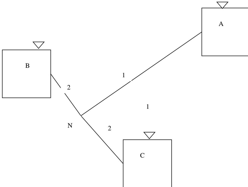
Si chiede di calcolare i valori delle 3 portate  $Q_1$ ,  $Q_2$ , e  $Q_3$
