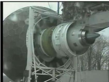
In sostanza, si tratta di una pompa; però poiché l'ingresso e l'uscita avvengono nell'ambiente, sorgono alcune complicazioni. Il fluido entra nella macchina attraverso la sezione 1 ed esce attraverso la sezione 2. Anche qui si impiega l'equazione globale per calcolare la spinta  $\vec{F}$  che fluido esercita sulla macchina. Si assumono le solite ipotesi di fluido incompressibile e di moto permanente.
