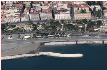
Scenario 4 - parete verticale con barriera di protezione distaccata
